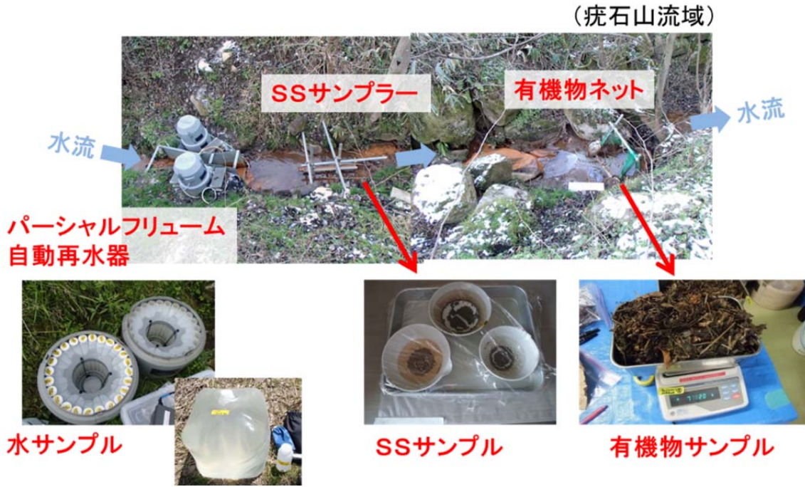
図-4 疣石山流域の水・SS・粗大有機物試料のサンプリング用観測機器の概要
